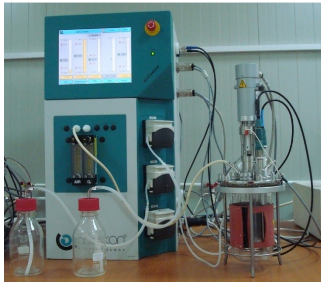
Fig. 1.1: Bioreactor Applikon de 1L pentru culturi de microorganismе (echipament din dotarea Platformei de formare si cercetare interdisciplinara Bioaliment , www.bioaliment.ugal.ro )
