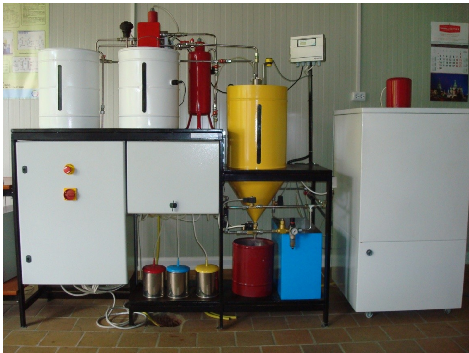
Fig. 1.2: Statia pilot de laborator pentru epurarea biologica a apelor uzate provenite din industria alimentara
